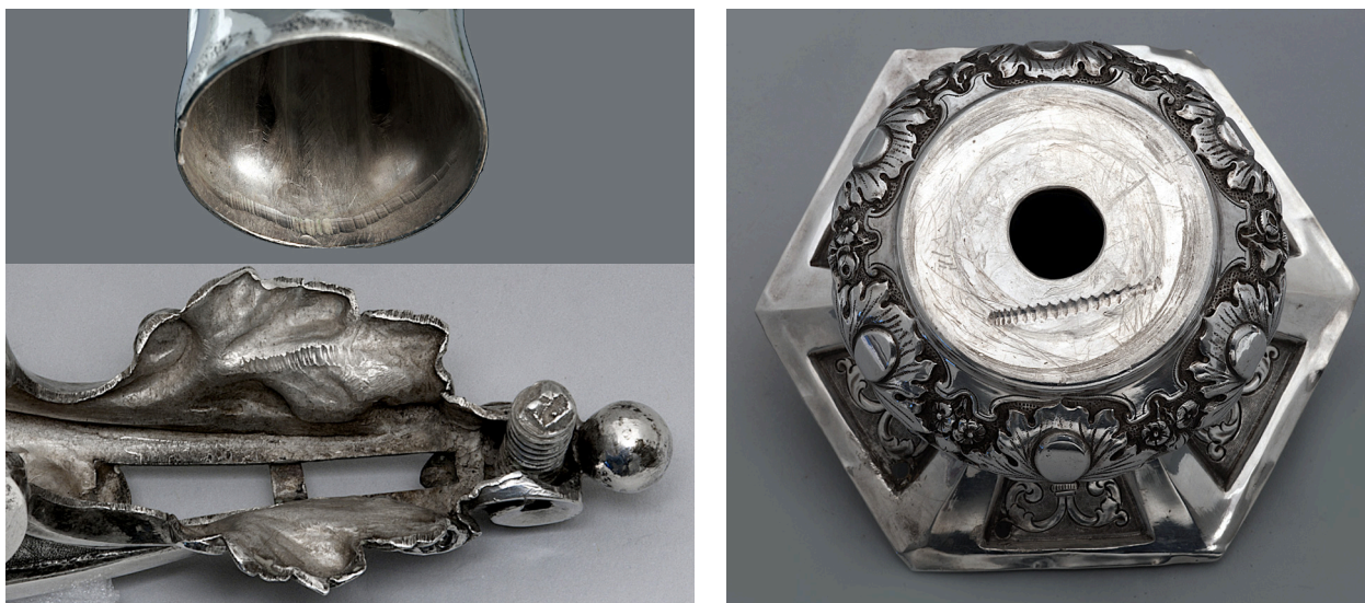
Figura 7. Detalle de las marcas o buriladas producidas por la extracción de una porción de plata para comprobar la ley del metal. Fotografía: Joaquín Otero.
