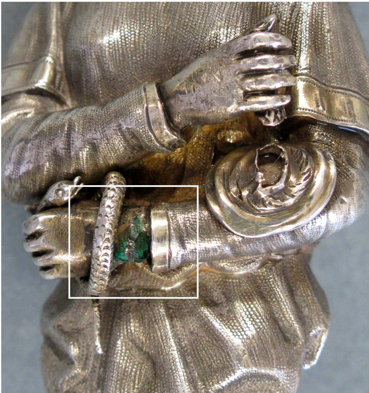
Figura 53. Productos de alteración de cobre localizados en la superficie de fractura de una de las manos de la figura de la Templanza / Prudencia. Fotografías de los autores. Fotografía de los autores.
