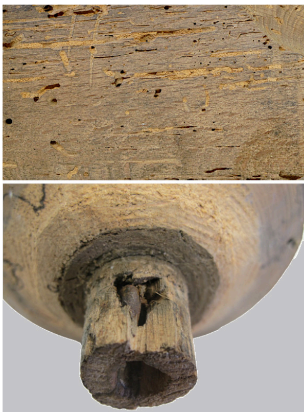
Figura 49. Deterioro de la madera. Arriba: detalle de las galerías originadas por insectos xilófagos. Abajo: inserción de un clavo de hierro en una zona con pérdida de materia. Fotografía: Joaquín Otero.
