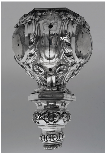
Figura 8. Localización de los puntos analizados mediante XRF en la cabeza de la maza MAM 12798. Información extraída del informe de la analítica. Fotografía: Joaquín Otero.
