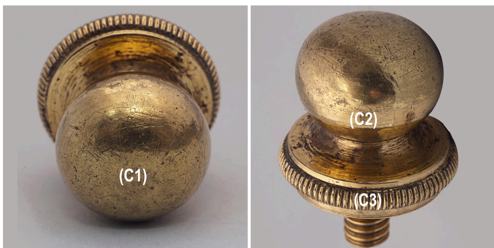
Figura 36. Puntos de toma de análisis de fluorescencia en la contera. Información extraída del informe de la analítica. Fotografía: Joaquín Otero.
