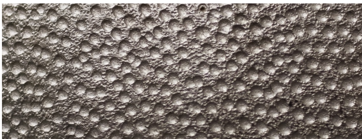
Figura 31. Superficie modificada mediante cincelado.
